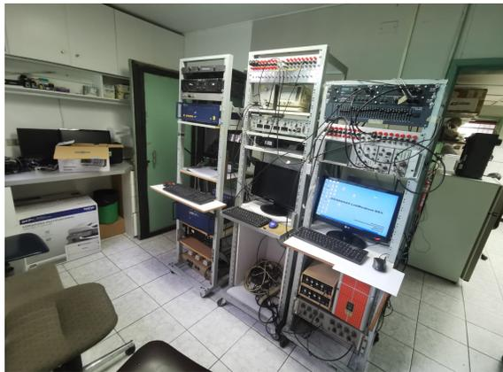
**Fig. 8. Laboratorio.** Se muestra una imagen del laboratorio, fuera de la cámara silente, con el equipamiento capaz de generar señales de las características de las DPOAE (Fuente: Confección propia).
